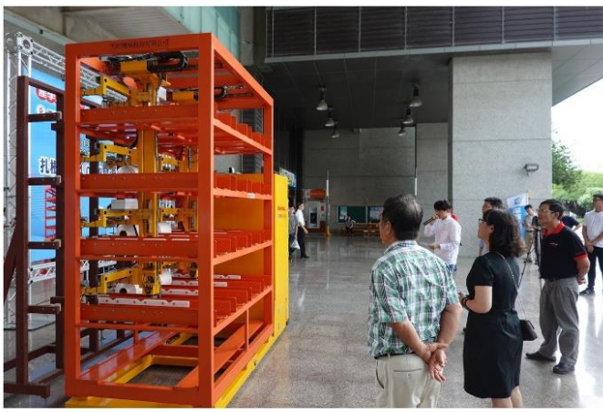
吳鳳科大電機系學生與天衍機械共同研發「假撚機自動落紗用自動導向車」。記者謝恩得 / 攝影
